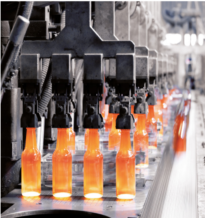
Le convoyeur de machines IS qui produit des produits creux en verre transporte les bouteilles chaudes jusqu'à la zone de stockage
