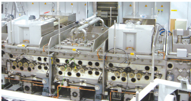
Chaînes dentées Biflex utilisées dans des installations de revêtement sous vide pour l'industrie solaire
