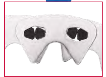
Optimisation des maillons de chaîne grâce au calcul par éléments finis
